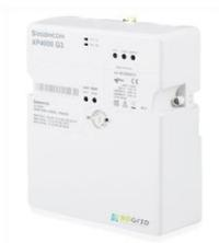
**2 Le data concentrateur** constitue le nœud de communication entre le réseau Moyenne Tension (HTA) et le réseau Basse Tension (BT). Il relaye les données et commandes émanant du système d'information SOGRID, et les exécute auprès des compteurs, en utilisant le CPL (courant porteur en ligne). *Développement Sagemcom.*
